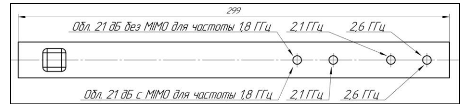
Схема 2 – Установка стойки облучателя антенны с усилением 21 дБ
