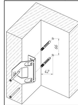
Схема 4 – Монтаж кронштейна
