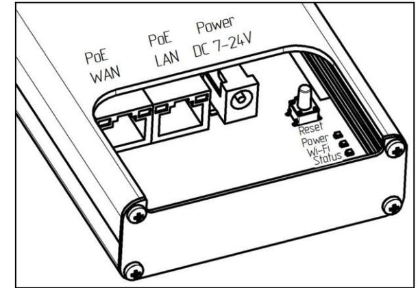
Рисунок 1 – Расположение портов и индикаторов роутера
