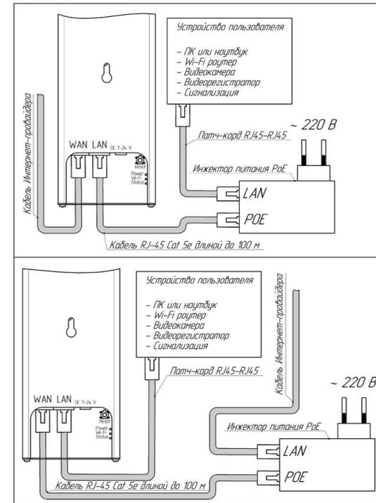
Схема 5 – Варианты подключения PoE инжектора питания
