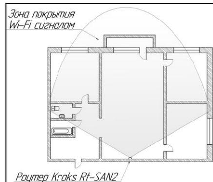
Схема 3 – Вариант установки роутера на стене
