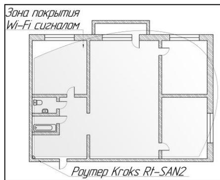
Схема 2 – Вариант установки роутера в углу
