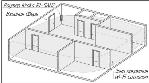
Схема 1 – Пример размещения роутера в квартире
