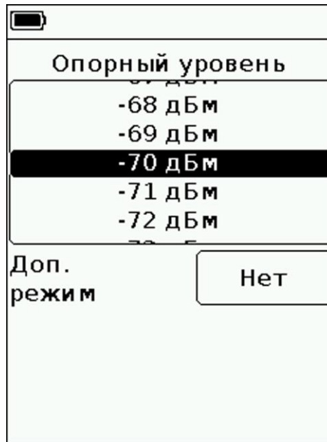
Рисунок 8.4.1 – Установка опорного уровня входного сигнала
